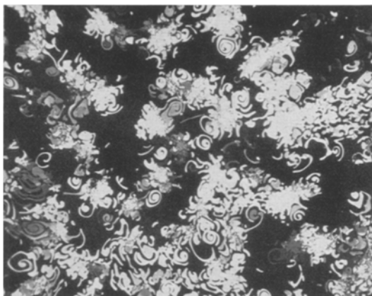
Abb. 7. Umlagerungsvorgang unter Bildung von Spiralen während des Schmelzens der „Zonenkristalle“ der Abb. 6.
